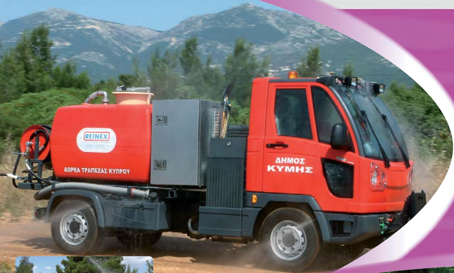
Feuerlöschanlage mit Selbstschutzeinrichtung
