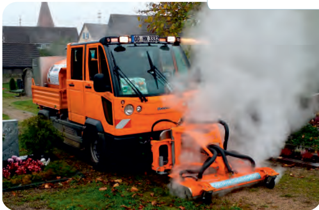
Flächenbehandlung bis zu 1600 mm mit Teilbreitenabschaltung
