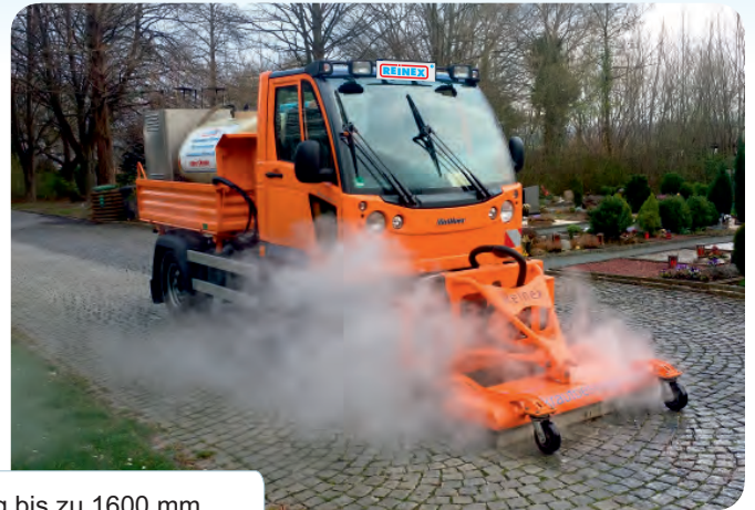
Flächenbehandlung bis zu 1600 mm mit Teilbreitenabschaltung
