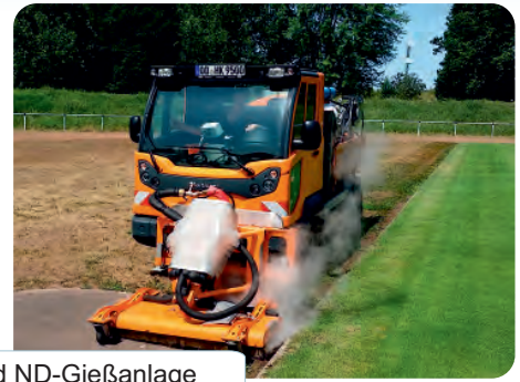
Wildkrautvernichtung in Kombination aus HD-Reinigung und ND-Gießanlage
