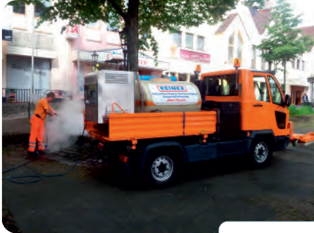
Wildkrautvernichtung in Kombination aus HD-Reinigung und ND-Gießanlage
