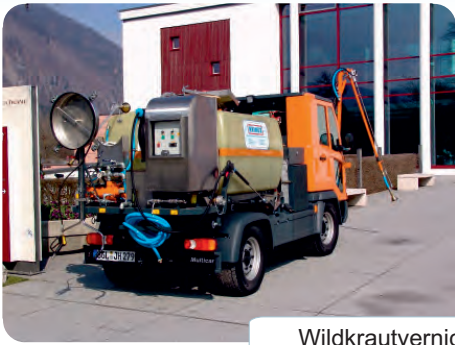
Wildkrautvernichtung in Kombination aus HD-Reinigung und ND-Gießanlage
