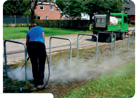
Wildkrautvernichtung in Kombination aus HD-Reinigung und ND-Gießanlage
