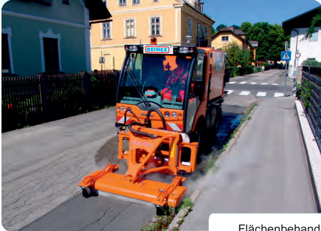
Flächenbehandlung bis zu 1600 mm mit Teilbreitenabschaltung
