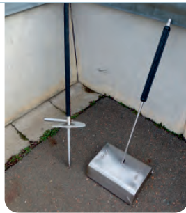
Handgeräte in verschiedenen Arbeitsbreiten von 100 - 1000 mm
